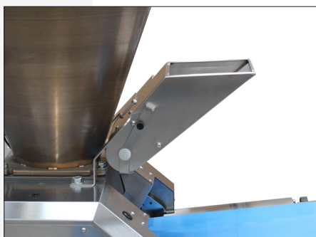
Sfarinatore. Flour duster. Mehlstreuer. Réducteur de farine. Espolvoreador de harina. Стройство для посыпания мукой с регулировкой количества выделяемой муки.
